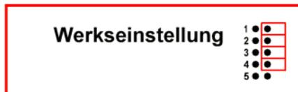
Рис.15, заводская установка переключки для режима внешнего управления
