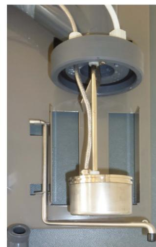
Рис 2, ультразвуковой генератор без ёмкости
