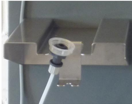
Рис 4, Место крепления всасывающего патрубка
