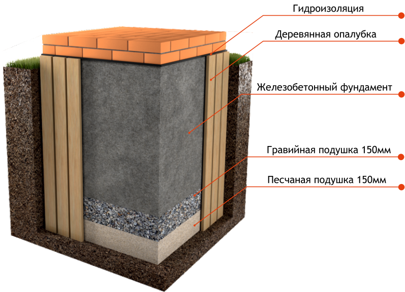
Рис. 3 Схема устройства фундамента
