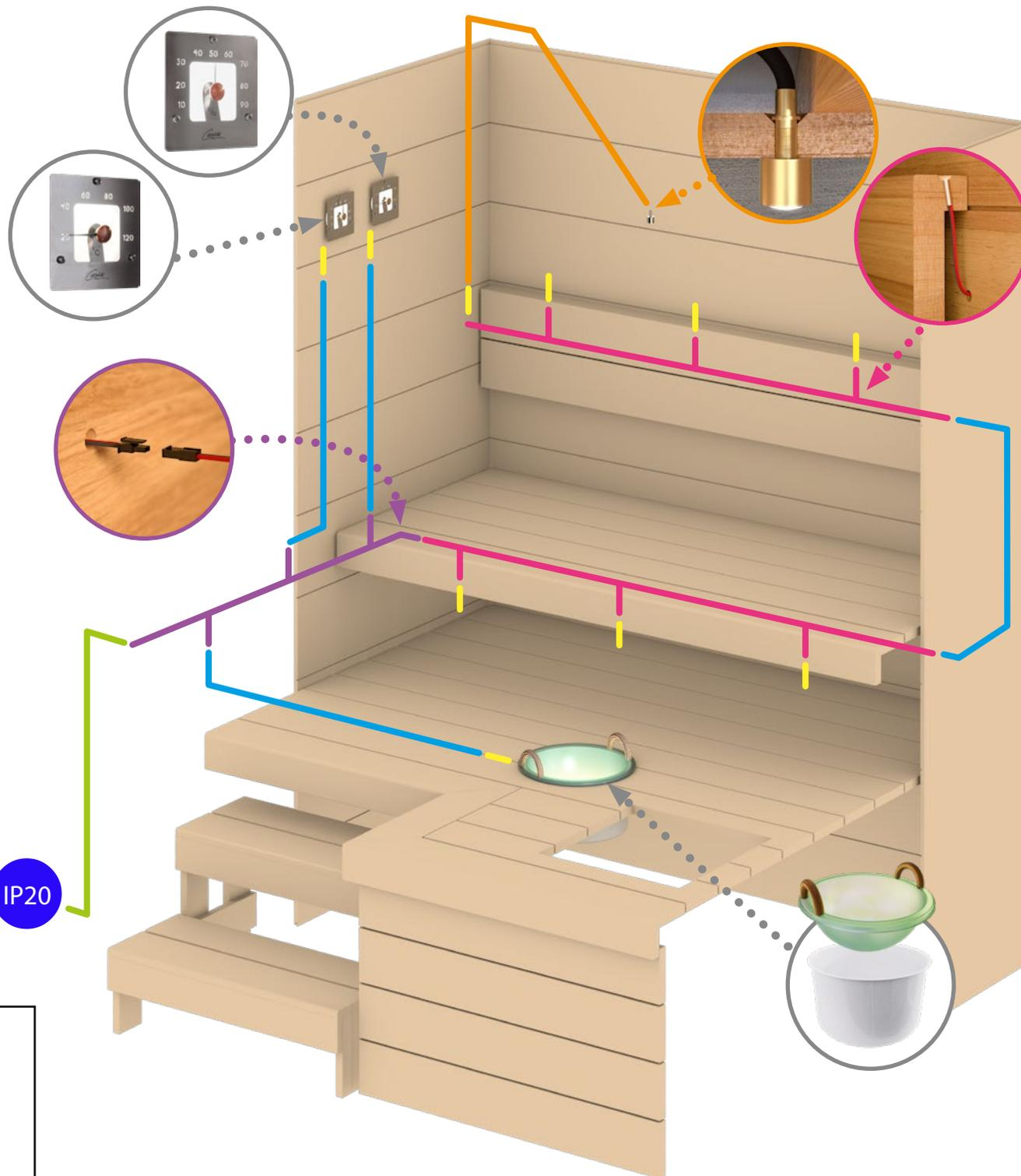
Если температура в сауне превышает +80°C, или печка в сауне обогрывается дровами, рекомендуем применять оптоволоконный комплект Cariitti. Макс. высота установки 190 см. Светодиоды нельзя устанавливать в потолке сауны!
