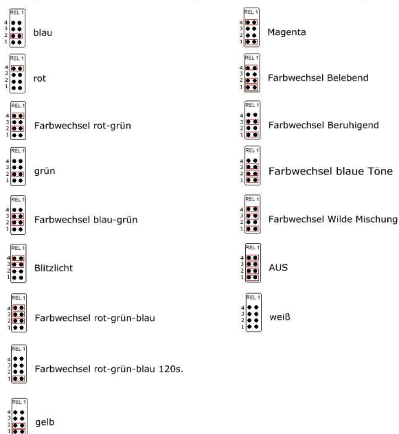
Jumper Positionen Relaisplatine Lichtsteuerung
