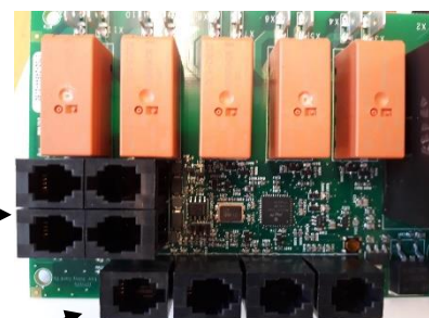
Afbeelding 4 . Volgorde van RJ10-stekkers. Sensor, deurschakelaar, afstandsbediening, extra NTC
