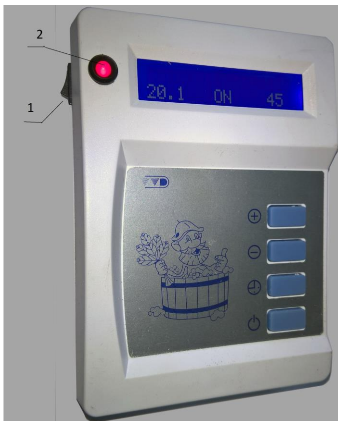
Рис 10. Электронный блок ПУ-01 МП
