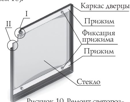
Рисунок 10. Ремонт светопрозрачного экрана дверцы.
